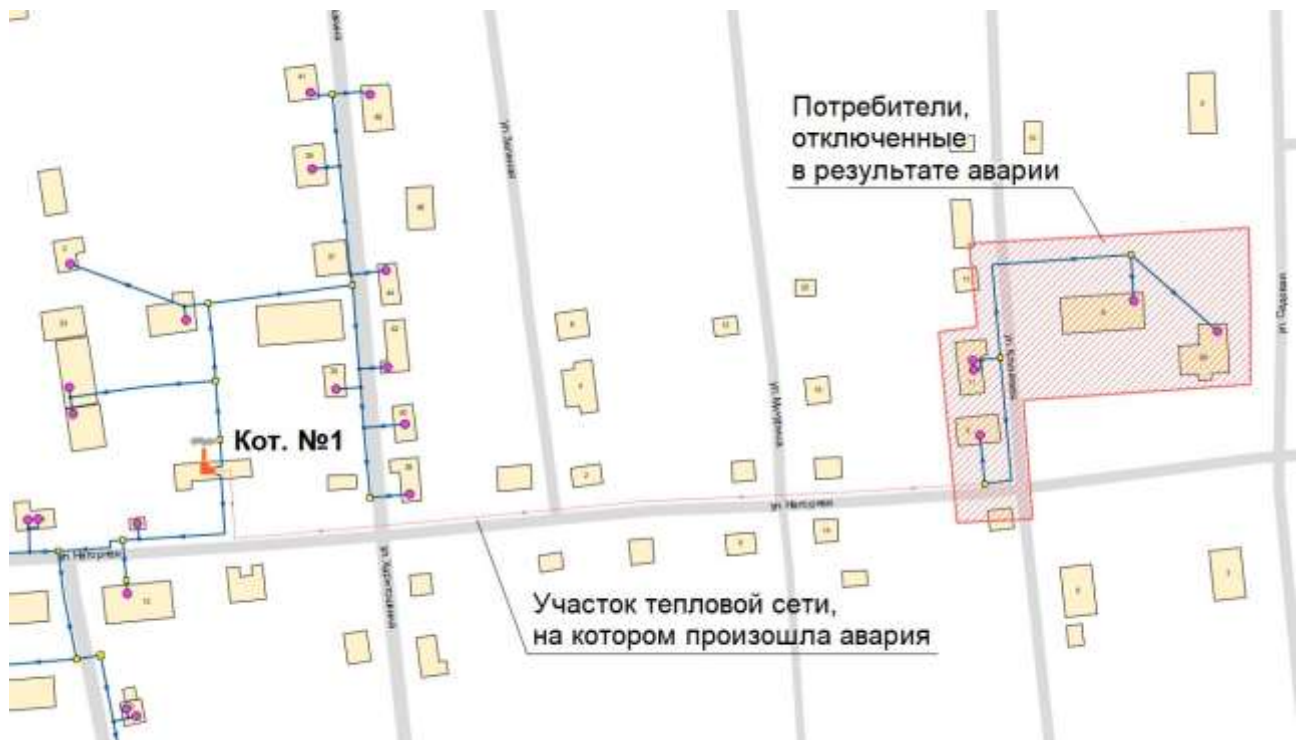
Рисунок 2.13 – Моделирование аварийной ситуации на котельной № 1, с. Усть-Кокса, сценарий № 1
