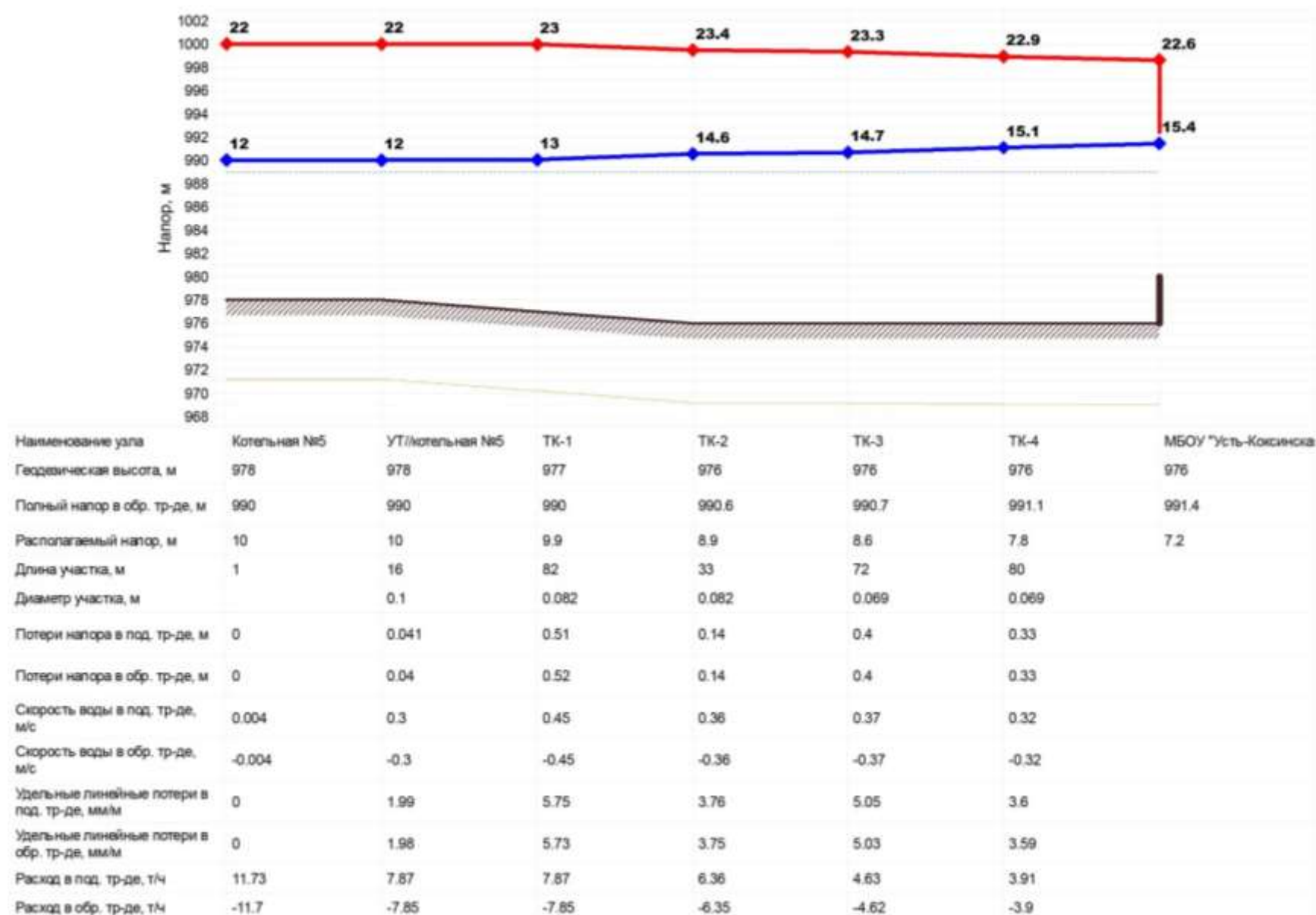
Рисунок 4.28 – Пьезометрический график от котельной №5 до детского сада (пер. Школьный, 3)
