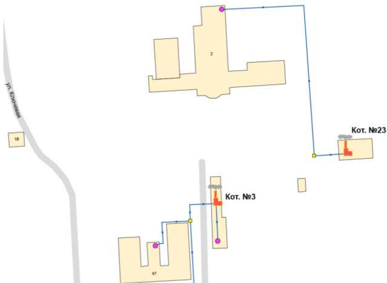
Рисунок 2.10 – Схема тепловых сетей в зоне действия котельной №23, с. Усть-Кокса
