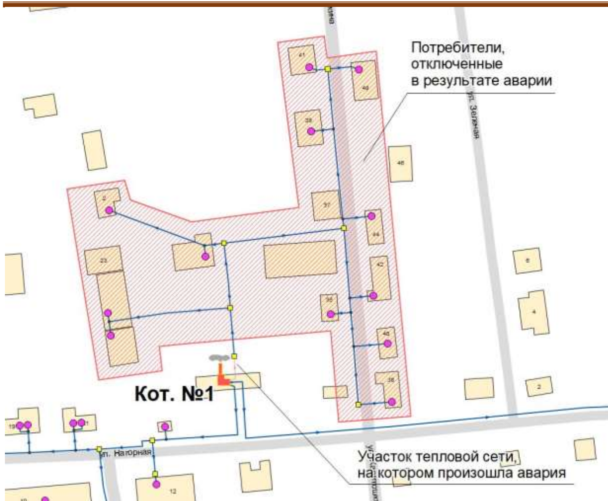
Рисунок 2.14 – Моделирование аварийной ситуации на котельной № 1, с. Усть-Кокса, сценарий № 2
