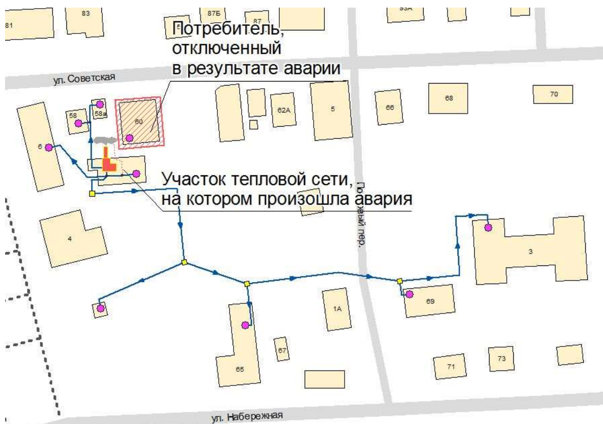
Рисунок 2.22 – Моделирование аварийной ситуации на котельной № 5, с. Усть-Кокса, сценарий № 3
